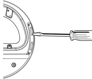
2. Quite los 4 tornillos que sostienen la bisagra de la puerta interior y mueva la bisagra al lado opuesto. Vuelva a instalar los 4 tornillos.
