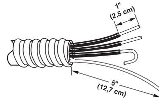
Al conectar el hilo al bloque de terminal, coloque el extremo del hilo en forma de gancho debajo del tornillo del bloque de terminal (con el gancho viendo hacia la derecha). Apriete y junte el extremo en forma de gancho y apriete el tornillo, como se muestra.
