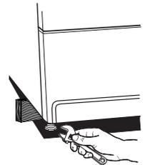
Si la secadora no está nivelada, apuntale la secadora, usando un bloque de madera. Use una llave de tuercas para regular las patas hacia arriba o hacia abajo y verifique nuevamente si la secadora está nivelada.
