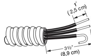
Al conectar el hilo al bloque de terminal, coloque el extremo del hilo en forma de gancho debajo del tornillo del bloque de terminal (con el gancho mirando hacia la derecha). Apriete y junte el extremo en forma de gancho y apriete el tornillo, como se muestra.
