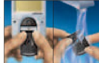
2. Utilice un hisopo o un paño humedecido con agua para limpiar el área de prueba. Séquela completamente. **Nota: No utilice alcohol. No sumerja el medidor en agua.**
