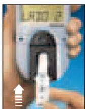
Si aparece **NO OK REPIT.** la lectura está fuera del rango aceptable de la tira de comprobación, el cual está impreso en la parte trasera del medidor. Limpie el medidor, repita la prueba. Si continúa **REPIT.** comuníquese al Servicio de atención al cliente de LifeScan en 1 800 381-7226.
