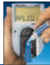
3. El resultado de la solución de control aparece en 45 segundos. Si el resultado de la solución de control se encuentra dentro del rango de control normal de OneTouch®, impreso en el frasco de tiras de prueba, el sistema está funcionando correctamente.
