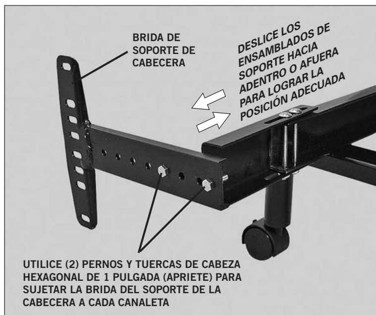
FIGURA 8: Instalación de la brida del soporte de la cabecera ( fije una brida a cada una de las canaletas del soporte de la cabecera ). ( Aquí se muestran patas con ruedecillas de 4" que son opcionales. )
