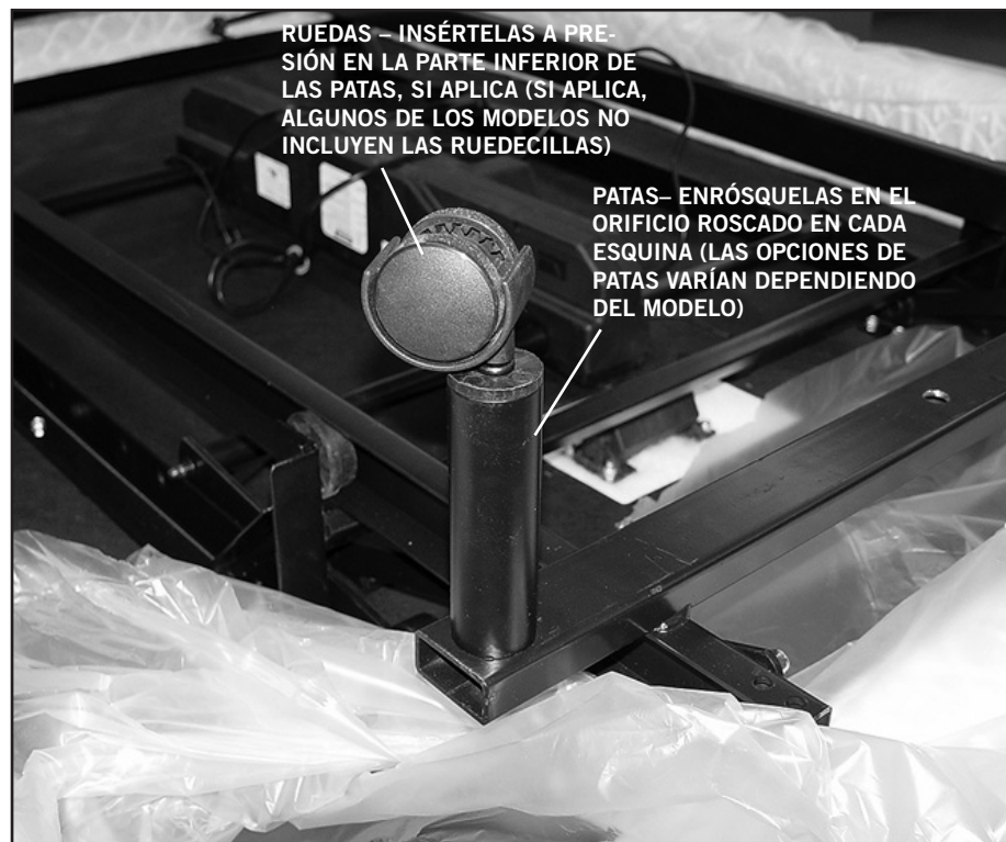
FIGURA 1: Instalación de patas. Instalación de ruedas, si aplica. (Aquí se muestran patas con ruedecillas de 4" que son opcionales.)
