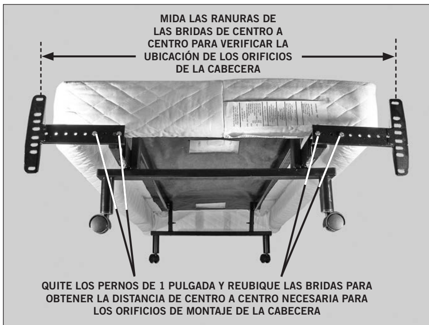
FIGURA 9: Medición y ajuste del soporte para colocar la cabecera. (Aquí se muestran patas con ruedecillas de 4" que son opcionales.)
