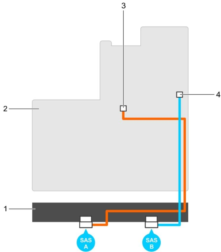
**Ilustración 1. Cableado de la controladora S130**
