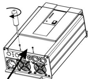
Antes de conectar la batería, deslice de nuevo la tapa del compartimento de conexión hasta su posición original y apriete los dos tornillos.
