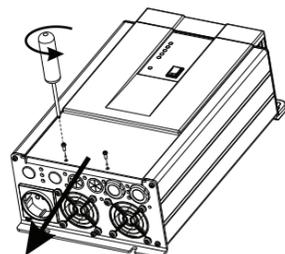
Para acceder al compartimento de conexión, extraiga los dos tornillos y deslice la tapa hacia abajo.
