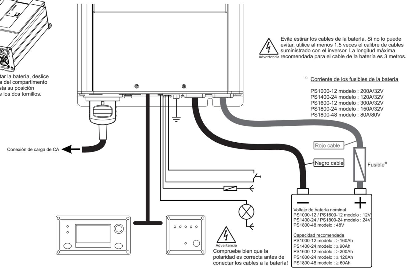
**Advertencia** Evite estirar los cables de la batería. Si no lo puede evitar, utilice al menos 1,5 veces el calibre de cables suministrado con el inversor. La longitud máxima recomendada para el cable de la batería es 3 metros.
