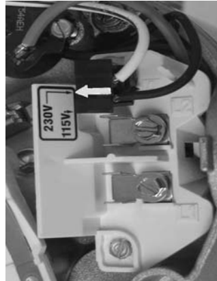
Figura 4A - Ficha de cambio de voltaje configurada para 230 Voltios.
