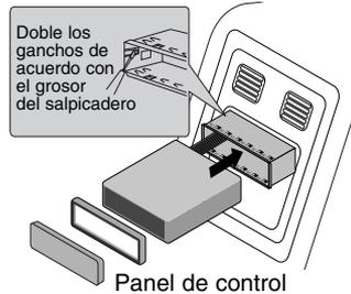
Antes de la instalación, asegúrese de que el interruptor de encendido se encuentre en OFF (APAGADO) y quite la terminal de la batería del automóvil para evitar un cortocircuito.
