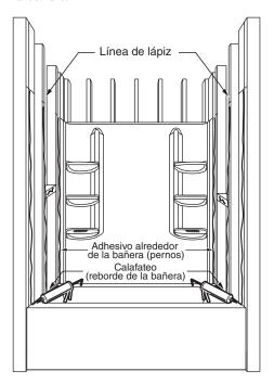
C) Alinee el reborde superior para clavar de cada panel lateral con la marca trazada a lápiz. Presione firmemente para asegurar una adhesión correcta de los pernos.
