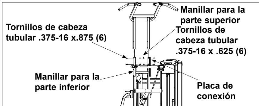
2. Alinee los agujeros con la placa de conexión. **NOTA:** Si los agujeros no se alinean, afloje los 12 tornillos de cabeza tubular que sujetan el manillar para la parte inferior a la estructura.
