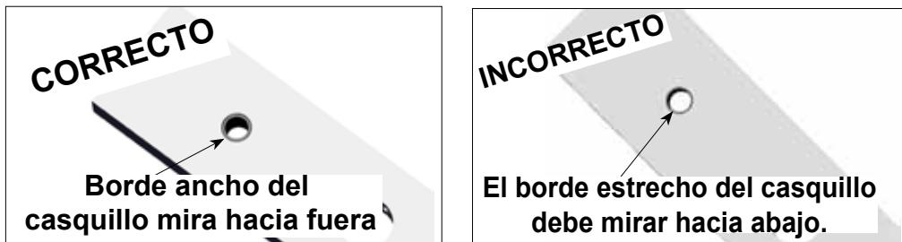
3. Instale el poste de levantamiento.
