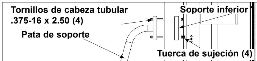
2. Introduzca los tornillos de cabeza tubular (incluidos en el kit) en los agujeros de la pata de soporte y en la estructura.
