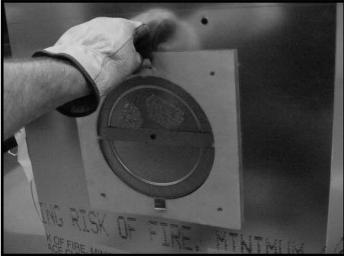
**Figura 7.6** Doble las pestañas hacia el centro de la tapa del tubo de escape (90°) y retire la junta aislante.
