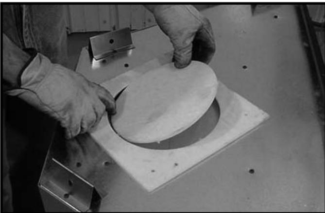
**Figura 7.2** Retire el tapón aislante central.
