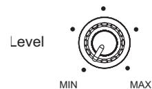
Una vez encontrado el ajuste en el control de volumen del altavoz de graves que equilibre el tono grave con el resto del sonido, en principio, no necesitará volver a cambiarlo.
