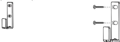
4. Después de hacer todas las conexiones que se describen en la sección de *Conexiones*, en la página 5, fije la barra de sonido en los soportes de pared, deslizando las pestañas verticales de los soportes en las ranuras de los topes de goma de la barra de sonido.
