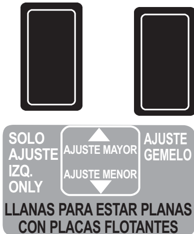
Figura 20. Interruptores oscilantes para ajuste de la llana
