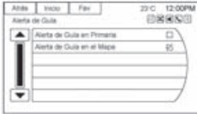
Presione para activar la alerta desplegable de orientación para verse en el mapa o las pantallas principales tales como radio, teléfono, etc. Aparece una marca de verificación para indicar que el modo de alerta de orientación está encendido.
