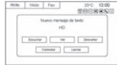
Se despliega una pantalla emergente cuando existe un texto entrante. La ventana emergente permanecerá en la pantalla hasta que se seleccione Descartar.
