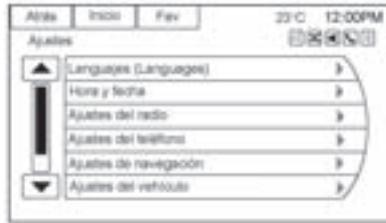
2. Toque y deslice la barra desplazable hasta que se proyecte la opción deseada. Seleccione la configuración que desea cambiar. Consulte el manual del propietario para información acerca del ajuste de la mayoría de las configuraciones del vehículo. Consulte “Ajustes de navegación” y “botón de Ajustes de navegación” en esta sección.
