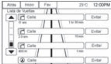
Seleccione Turn List (Lista de vueltas) para ver una lista de maniobras para la ruta completa. Oprima el botón de pantalla Avoid (Evitar) enseguida de una de las maniobras de vuelta para evitar un segmento de caminos. Se permite evitar un máximo de ocho segmentos.
