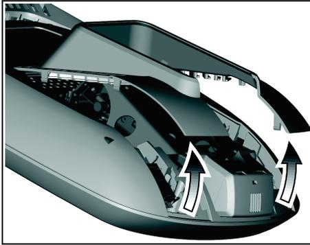
**Figura 23:** retirada de las cubiertas de acceso de la consola P80
