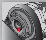
COMPRESOR DESACTIVADO (el embrague está fijo)
