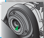
COMPRESOR ACTIVADO (el embrague está girando)
