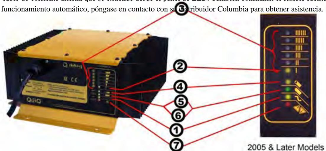
2. Cargador automáticamente se encienda y realizar una breve prueba de paquete autocomprobación y batería. Todos LED parpadeará en secuencia y, a continuación, una corriente de goteo se aplicará a las baterías hasta que se alcanza un voltaje mínimo. Tres 3 amperios se muestra como el LED más bajo sobre el gráfico de barras. Ver (2) en la siguiente figura.
