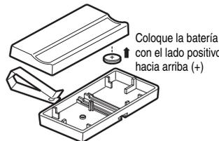
Coloque la batería con el lado positivo hacia arriba (+)
