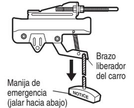
*El dispositivo de cierre evita que el carro se vuelva a conectar automáticamente. Tire de la manija de emergencia hacia abajo y hacia atrás. (hacia el abre-puertas de garaje). La puerta se puede subir y bajar manualmente siempre que sea necesario. Para desenganchar la función de cierre, tire la manija directamente hacia abajo. El carro se volverá a conectar la próxima vez que accione hacia ARRIBA o hacia ABAJO.*
