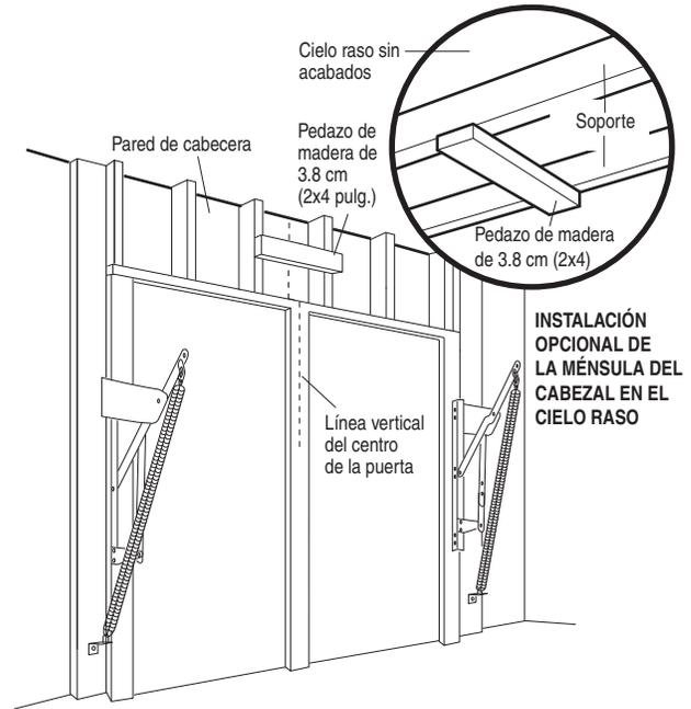
**INSTALACIÓN OPCIONAL DE LA MÉNSULA DEL CABEZAL EN EL CIELO RASO**
