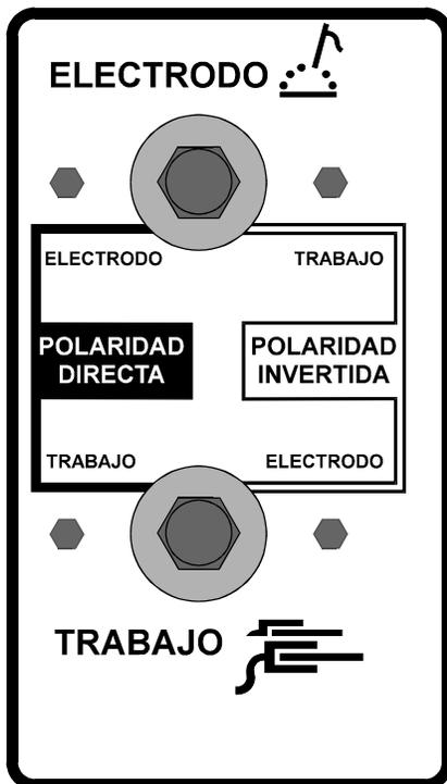
**TERMINAL PARA ELECTRODO Y TERMINAL PARA TRABAJO.** Estas terminales secundarias se localizan en la parte inferior de la máquina y deberán conectarse de acuerdo a lo siguiente:
