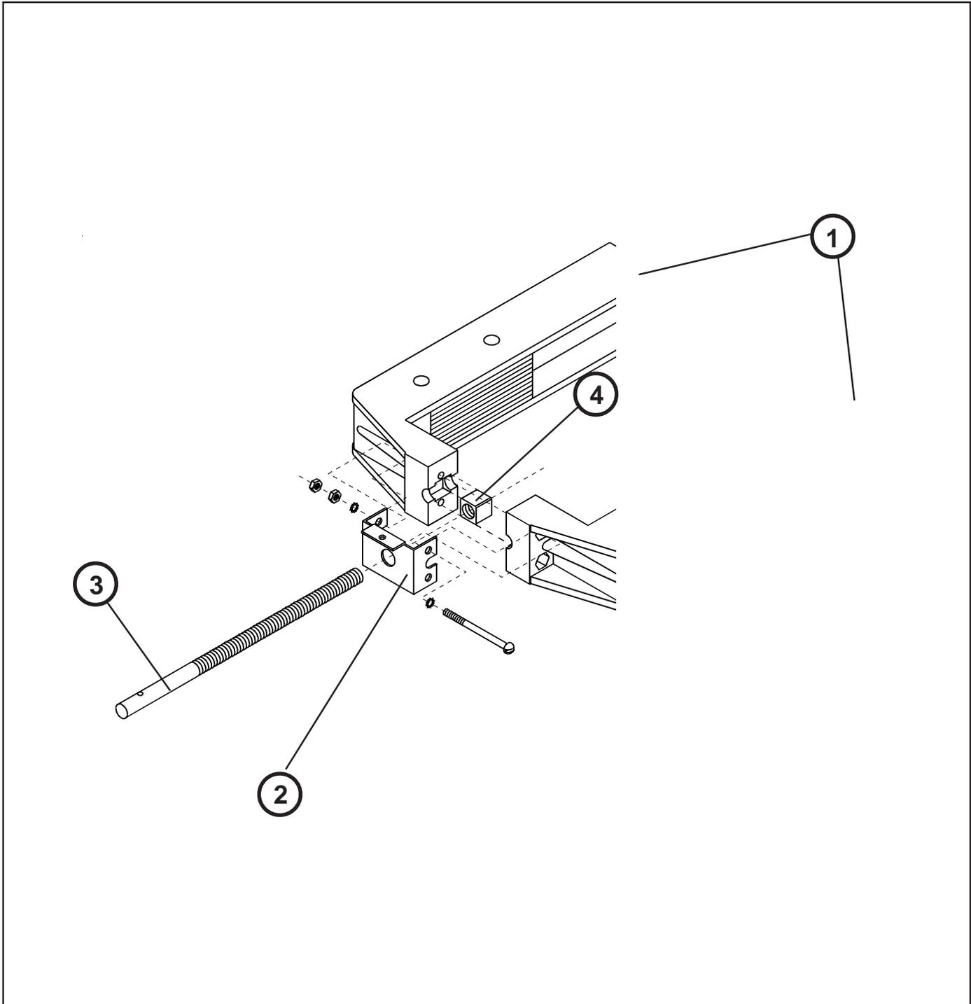
**Figura 7- 3 Ensamble del Shunt**
