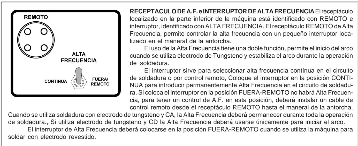
**Figura 4-8 Receptáculo de A.F e Interruptor de Alta Frecuencia.**
