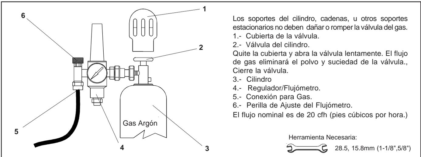
**Figura 4-14 Instalación del Gas y el Regulador/Flujoímetro.**
