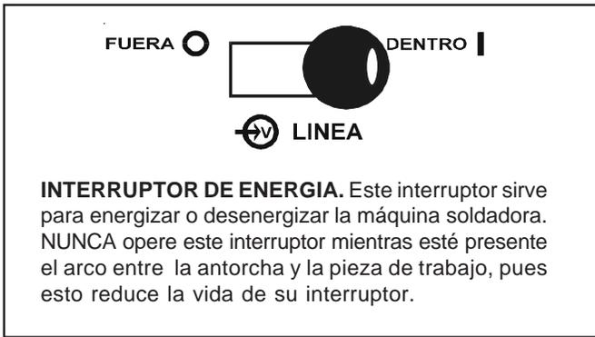
**Figura 4-4 Interruptor de Energía.**
