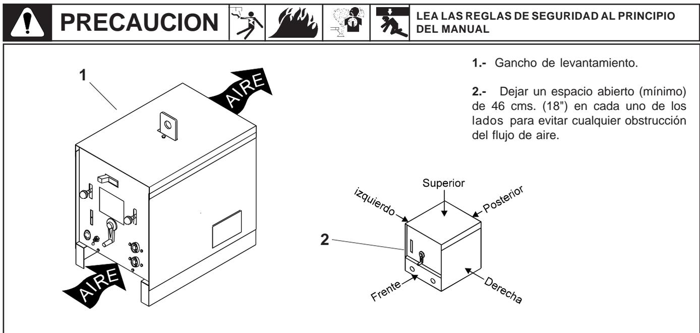
Figura 3-1 Localización y Movimiento de la Máquina Soldadora.
