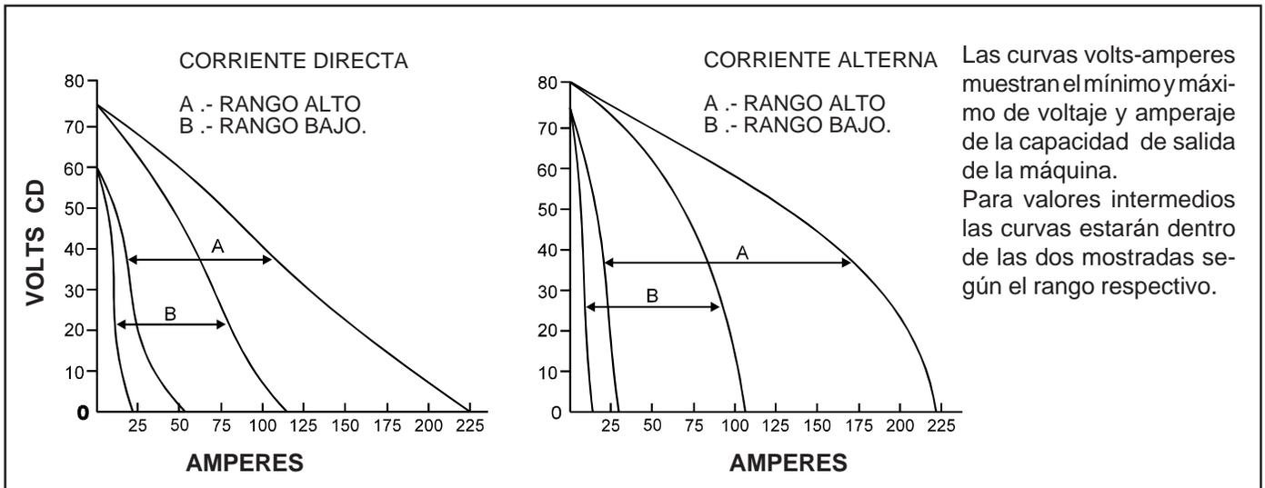
**Figura 2-1 Curvas Volts-Amperes.**
