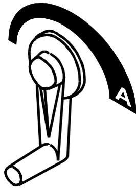
**CONTROL DE AJUSTE DE CORRIENTE.** Esta máquina posee un control para seleccionar la corriente de soldadura que requiera para alguna aplicación particular.
