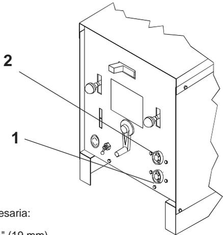
1 - TERMINAL DE TRABAJO. Use esta terminal para conectar el cable de trabajo. Asegúrese que la terminal este lo suficientemente apretada.
