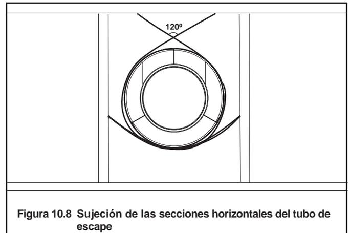
Figura 10.8 Sujeción de las secciones horizontales del tubo de escape
