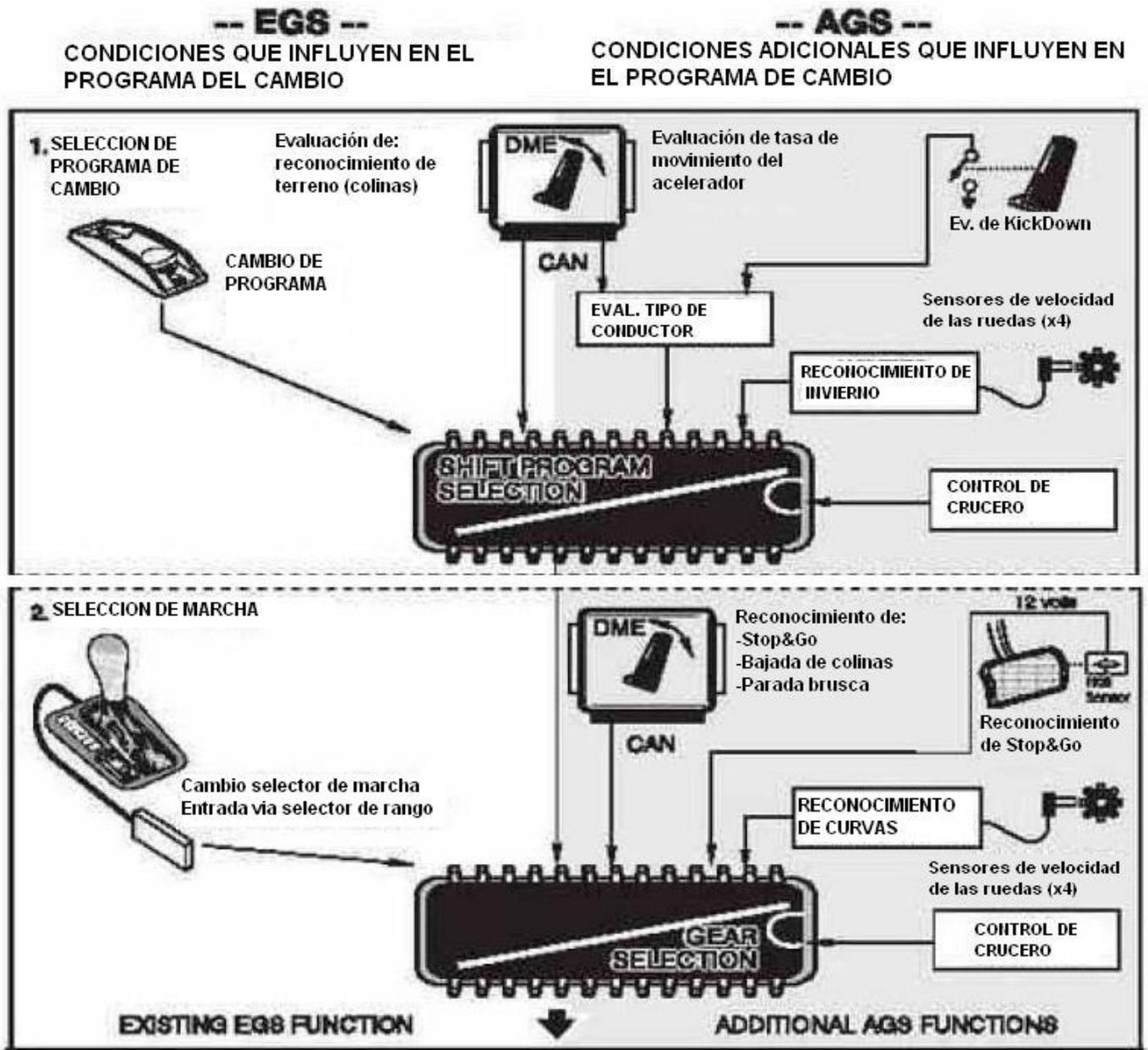
La selección de un programa de conducción no se mantiene a largo plazo, ni se almacena en la memoria del módulo de control cuando se apaga el coche. Continuamente cambia, según el conductor del vehículo cambia sus hábitos de conducción.
