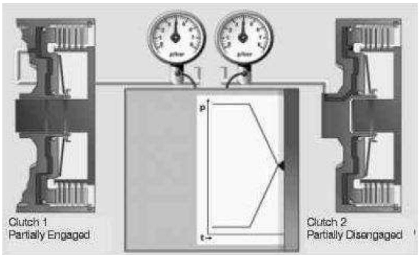
La nueva marcha se engrana en el momento que el nivel de par supera al del primer embrague. Esto es lo que se llama solapamiento. Si el solapamiento es correcto (cero solapamiento) el embrague que entra lleva mucho más par que el que se está liberando. El resultado es un aparentemente inapreciable cambio de la mejor calidad.
