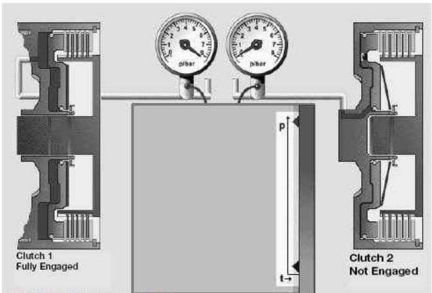
Como muestra el diagrama anterior, el embrague 1 está completamente pisado con máxima presión, el embrague dos está completamente liberado.
