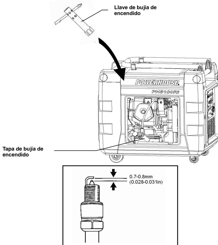
6. Limpie la bujía de encendido con un cepillo de cable si debe volver a utilizarla.
