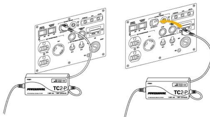
5. Cargue la batería por 3 horas o hasta que esté completamente cargada. Una vez que la batería está completamente cargada, desconecte el cargador de batería y retire el cable cargador interno.
