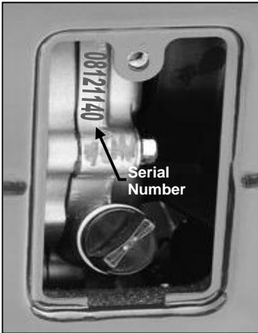
El número de serie del motor se encuentra impreso en el bloque del motor sobre la varilla medidora de aceite. Es visible cuando se extrae la tapa de acceso al aceite del motor.
