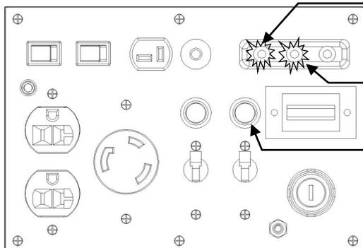
**Sobrecarga:** La luz roja de sobrecarga se enciende cuando el generador esta sobrecargado o tiene un corto circuito.
