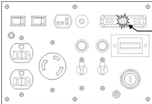
**Luz de encendido:** La luz verde de encendido indica condiciones normales de funcionamiento.
