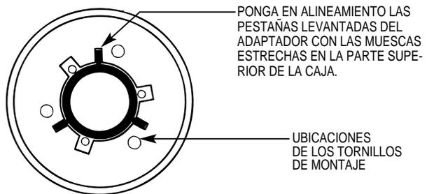
VISTA: MIRANDO HACIA ABAJO SOBRE LA PARTE SUPERIOR DEL VENTILADOR MOSTRANDO EL ALINEAMIENTO DE LA PESTAÑA CON LA MUESCA
