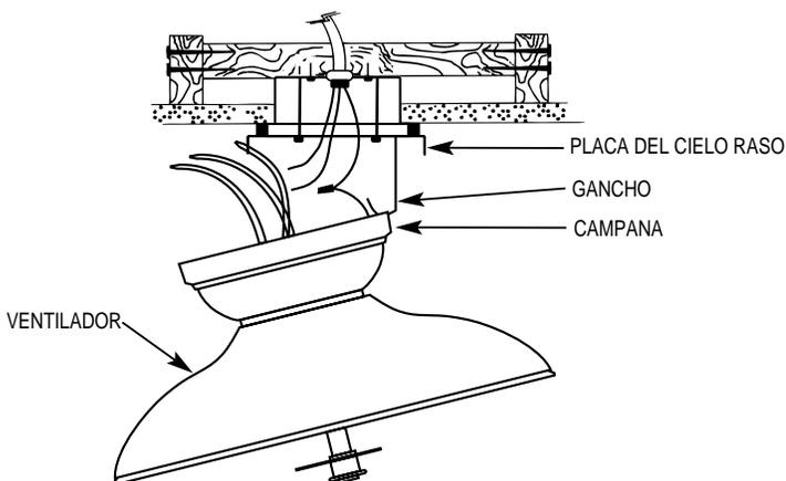
**FIGURA 5A.** Forma de colgar el ventilador
