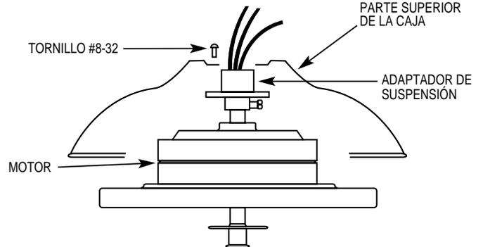
**FIGURA 4C.** Instale la parte superior de la caja
