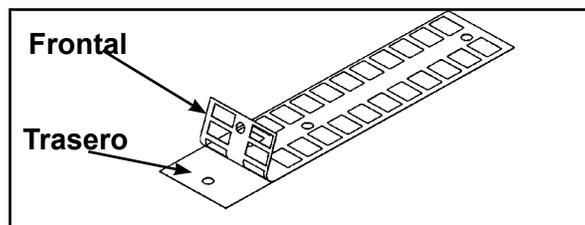
2. Inserte un pasador guía a través de cada agujero de la plantilla. Un pasador guía puede ser cualquier objeto que encaje a través del agujero de la pila de pesos, tal como un perno de selección de la pila de peso.
