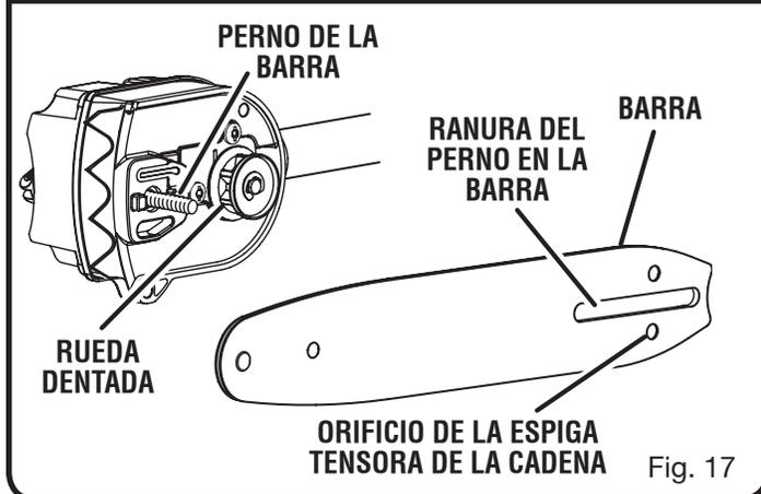
barra. La barra debe quedar libre para moverse para el ajuste de la tensión.
