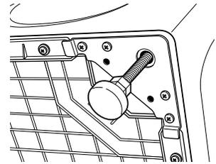
**NOTA:** Mantenga la extensión de los soportes al mínimo para evitar una vibración excesiva. Cuanto más se extiendan los soportes, más vibrará la lavadora.
