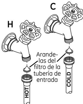
5. Conecte los extremos de la tubería de entrada a las tomas de agua CALIENTE y FRÍA ajustándolos con la mano y, a continuación, apriete de nuevo 2/3 de vuelta con los alicates. Abra la llave de paso y compruebe que no hay ninguna fuga.
