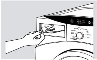
**Zona del depósito de detergente:** El detergente y el suavizante pueden acumularse en el depósito de detergente. Los residuos deben eliminarse una o dos veces al mes.
