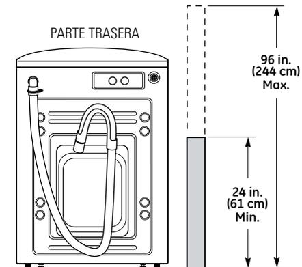
**NOTA:** La tubería de desagüe de la lavadora puede alcanzar la altura de una tubería vertical de 58" (147 cm). Para una tubería vertical más alta, póngase en contacto con un distribuidor de piezas autorizado.
