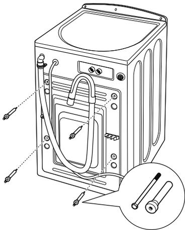
**NOTA:** Si se retiran incorrectamente los pernos de transporte, puede que la lavadora se vea gravemente desequilibrada.
