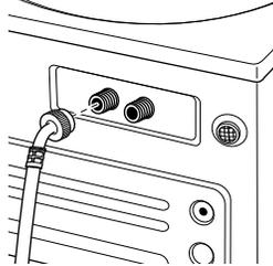
la tubería de entrada marcada con HOT (Caliente) a la salida "H" exterior de la válvula de agua. Apriete con la mano y, a continuación, apriete 2/3 de vuelta con los alicates. Conecte con cuidado la otra tubería de entrada a la salida "C" interior de la válvula de agua. Apriete con la mano y, a continuación, apriete 2/3 de vuelta con los alicates. **No pase las roscas ni apriete excesivamente estas conexiones.**
