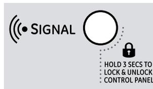
Para bloquear la lavadora, mantenga pulsado el botón de **DELAY START** (Retrasar inicio) durante 3 segundos. Para desbloquear los controles de la lavadora, mantenga
