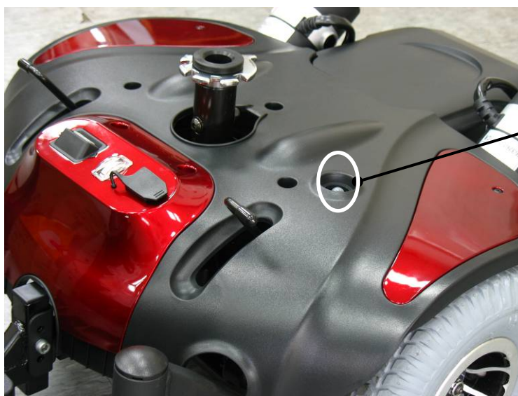
Interruptor de Circuito
