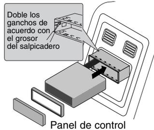
Antes de la instalación, asegúrese de que el interruptor de encendido se encuentre en OFF (APAGADO) y quite la terminal de la batería del automóvil para evitar un cortocircuito.
