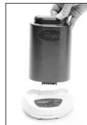
**PRECAUCIÓN** Evite tocar los contactos eléctricos clausurados del cargador de batería externo; el daño de los contactos podría afectar el funcionamiento del cargador.
