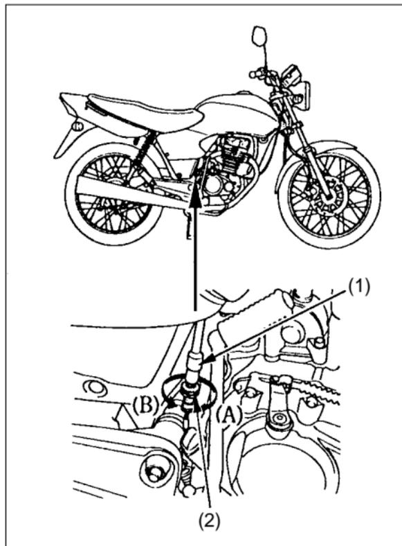
(1) Interruptor de la luz      (2) Tuerca de ajuste del freno
