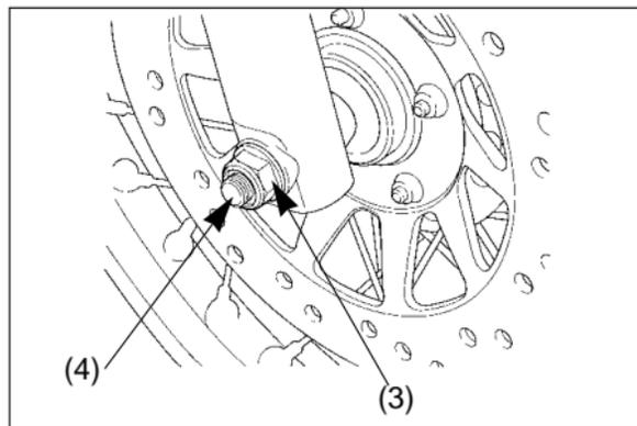
(3) Tuerca del eje (4) Eje delantero
