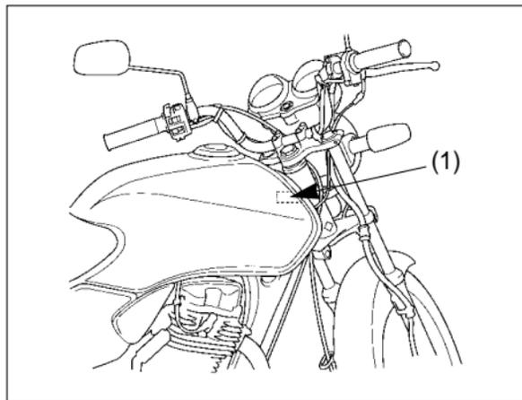
(1) Placa de identificación del año de fabricación
