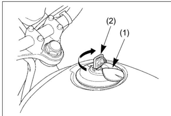
(1) Tapa del tanque      (2) Llave de encendido
