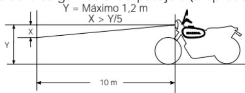
Obs.: El haz de luz del faro debe alcanzar máximo 100 m.
