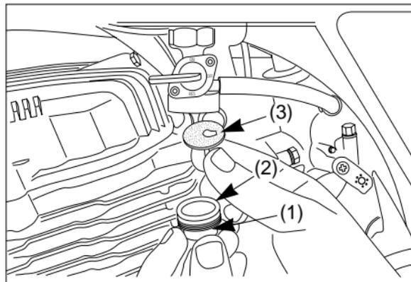
4. Instale nuevamente la malla del filtro en el cuerpo de la válvula, alineando las marcas de referencia. Reemplaze el anillo de sellar. Instale nuevamente manualmente la taza del filtro, certificándose de que el anillo de sellar esté en su posición adecuada. Apriete enseguida la taza del filtro.
