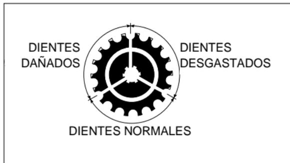
5. Si la cadena de transmisión y las ruedas dentadas están excesivamente desgastadas o dañadas, se debe reemplazarlas.
