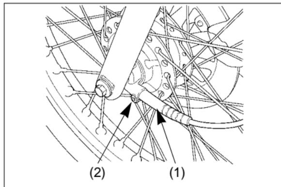
(1) Cable del velocímetro (2) Tornillo
