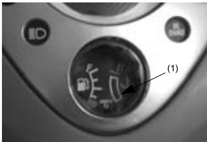
(1) Medidor de las temperatura del fluido refrigerador
