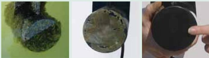
Limpie el cabezal del transductor con un trapo o esponja suave, para eliminar la suciedad y los residuos. En algunos casos, con materiales orgánicos o depósitos de calcio, puede ser necesario utilizar vinagre o ácido clorhídrico para limpiar el cabezal. No utilice limpiadores abrasivos que puedan arañar el cabezal.
