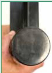
Utilice un trapo suave para limpiar la superficie y aproximadamente 2,5 cm del borde frontal del transductor.
