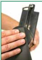
Comience con un transductor limpio y seco, utilice una lija húmeda de grano 800 para lijar la superficie del transductor y la primera pulgada del lado del frente para eliminar los arañazos profundos. A continuación, repita el procedimiento de pulido con una lija húmeda de grano 1000. Finalmente, vuelva a repetir el procedimiento con lija húmeda de grano 1500. El cabezal del transductor quedará completamente suave cuando haya terminado.
