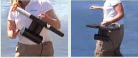
Vuelva a colocar la unidad en el agua orientada en la dirección correcta. Asegúrese de que el extremo plano del cabezal del transductor (no el lado con el cable) quede orientado hacia fuera.
