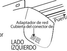
3 Quite el Adaptador de la Red de su envase e insértalo en el puerto con el alambre de antena frente a plumón. Pon derecho la antena si necesitó para que sea tan largo como posible.
