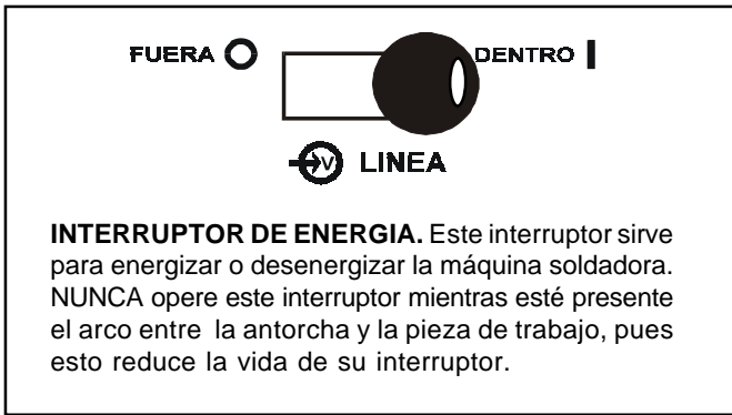
Figura 4-4 Interruptor de Energía.
