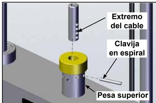
3. Coloque la clavija de la pila de pesas en cada placa para que queden instaladas de manera correcta.
