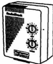
**Precaución:** Utilice los módulos para equipos de iluminación únicamente. Algunos equipos se pueden dañar mediante el uso de circuito oscurecedor. No utilice este tipo de módulo con instalaciones de luz que tengan oscurecedores integrados.
