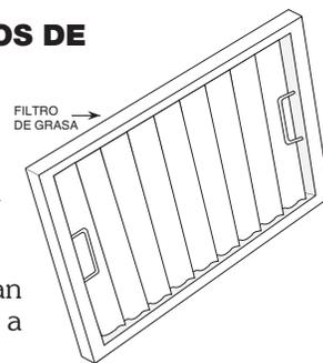
Para desmontar el filtro de grasa, tire del mismo hacia afuera hasta sacarlo de su carcasa desde el otro lado. Coloque el filtro en el lavavajillas o lávelo por separado introduciéndolo en agua caliente con jabón hasta que se hayan eliminado todas las partículas y la grasa. Enjuáguelo abundantemente. Deje secar el filtro al aire antes de volver a colocarlo.
