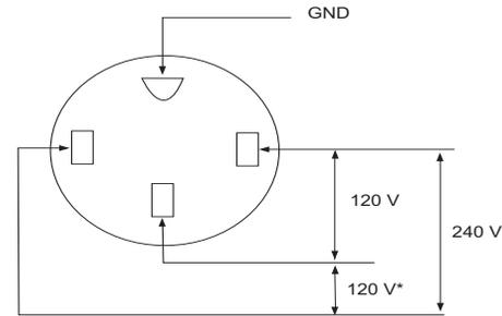
\*Sensión de Corriente para Velocidad Automática (Receptáculo visto desde el frente de la Máquina)
