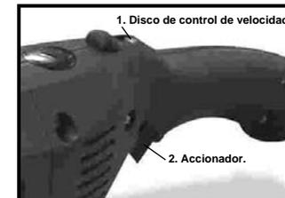
La pulidora cuenta con un disco de control de velocidad, que controla las rotaciones máximas por minuto de la pulidora. La velocidad permanecerá en el valor seleccionado en el disco usando el interruptor de disparo. Los valores del disco son del 1 al 5. Los números más bajos corresponden a velocidades más bajas, y los números más altos corresponden a velocidades más altas.
