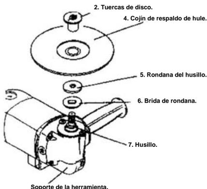
1. Para instalar los cojines para pulir, desconecte la herramienta y colóquela en el soporte de la herramienta con el husillo en posición vertical.
