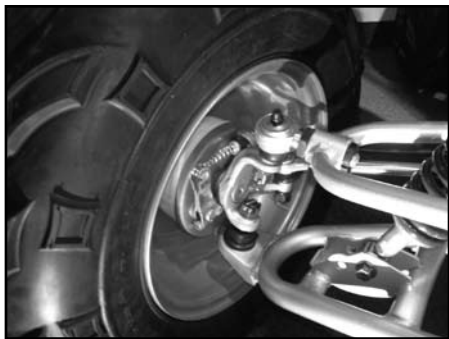
Rueda delantera con freno de tambor a expansión interna
