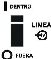
**INTERRUPTOR DE LINEA.** Este interruptor sirve para energizar o desenergizar la máquina soldadora. **NUNCA** opere este interruptor mientras esté presente el arco entre la antorcha y la pieza de trabajo, pues esto reduce la vida de su interruptor.
