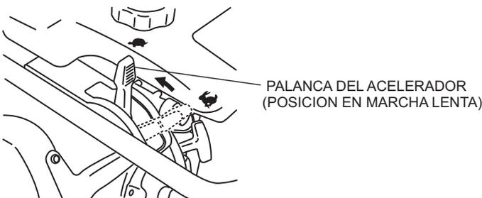
**Figura 9. Palanca del acelerador (Posición de marcha lenta)**
