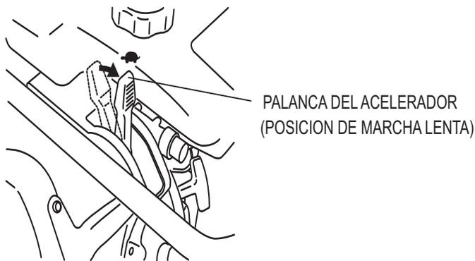
**Figura 5. Palanca del acelerador (Posicion en marcha lenta)**
