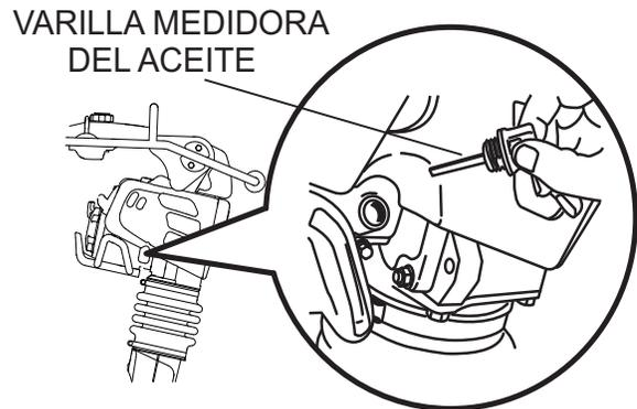
**Figura 4. Varilla medidora del aceite del motor**
