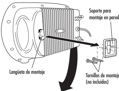
3. Coloque el calefactor de costado y ubique la pestaña de montaje en la parte trasera del mismo, de modo que quede alineada con el soporte de montaje.
