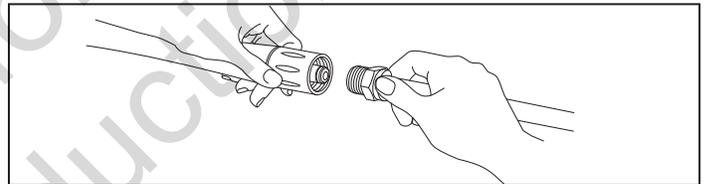
7. Elija la punta de rocío que desee, desplace hacia atrás el anillo de extensión para boquillas, inserte la punta de rocío y suelte el anillo. Tire de la punta de rocío para comprobar que está bien montada. Consulte la sección *Cómo usar las puntas de rocío*.
