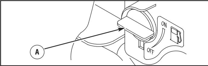
9. Mueva el palanca del acelerador (A) a la posición "Rápido" ("Fast")
