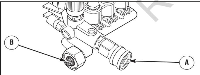
3. Antes de que conecte la manguera de jardín a la entrada de agua, inspeccione el colador de la entrada (B). Limpie el colador si tiene residuos o solicite su repuesto si está dañado. NO haga funcionar la máquina limpiadora a presión si el colador de la entrada está dañado.
