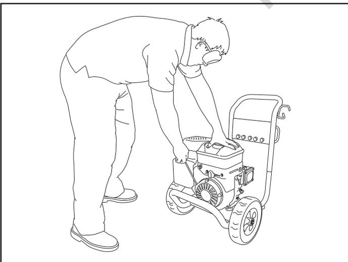
**⚠ ADVERTENCIA** El retroceso (repliegue rápido) del cable del arrancador impedirá que el usuario suelte el cable a tiempo y tirará de su mano y brazo hacia el motor, lo que podría provocar fracturas, contusiones o esguinces; así como lesiones graves.
