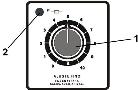
**1 CONTROL DE AJUSTE FINO DE CORRIENTE.** El control de ajuste de corriente ajusta desde un mínimo a un máximo de corriente dentro del rango fijado en el selector de rango.
