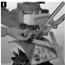
Installez la fixation universelle (no 2) sur les tubes des poignées de la motobêche, sous le réservoir de carburant.
