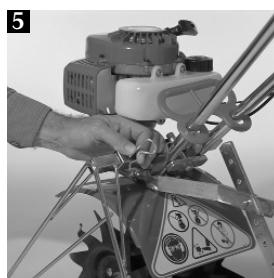
Finalmente, inserte el vástago retenedor en el soporte universal que sostiene firmemente los protectores derecho e izquierdo.
