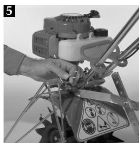
Insérez la goupille de sécurité fixant le bras gauche et le bras droit du protège-plantes dans la fixation universelle.
