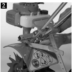
Positionnez la plaque métallique (no 5) sous les tubes et introduisez le boulon (no 6) dans le trou taraudé de la fixation universelle (no 2).
