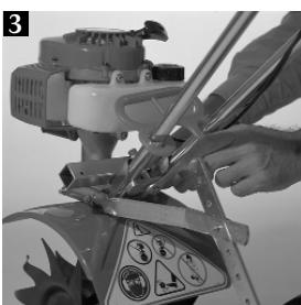
**3** Apriete el tornillo (clave # 6) hasta que el soporte universal (clave # 2) esté firmemente sujetado en los manubrios de la excavadora.
