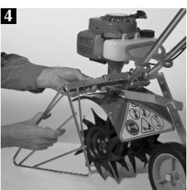
**4** Inserte sobre el soporte universal el protector de las plantas del lado derecho e izquierdo (claves #1 y 4). Asegúrese de que la cara del protector de las plantas esté hacia abajo, según se ilustra.
