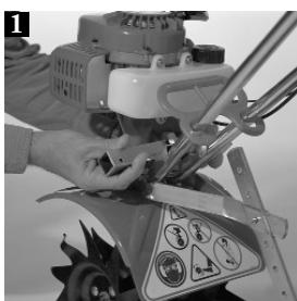
**1** Instale firmemente el soporte universal (clave # 2) por debajo del tanque de combustible y hacia los manubrios de la excavadora.
