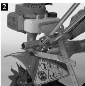
**2** Coloque la placa metálica (clave # 5) por debajo de los manubrios de la excavadora, e inserte el tornillo (clave # 6) en la perforación con cuerda del soporte universal (clave # 2).
