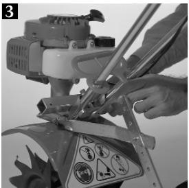
Serrez le boulon (no 6) jusqu'à ce que la fixation universelle (no 2) soit bien fixée sur les tubes des poignées.
