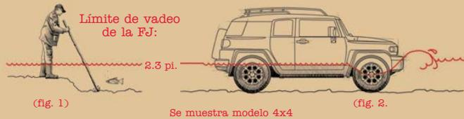
**Fig. 1:** Al cruzar agua, camina primero por la ruta para determinar la profundidad, la firmeza del fondo y la ubicación de los obstáculos. Conoce el límite de vadeo del vehículo para que la entrada del motor no trague agua.<sup>1</sup>
