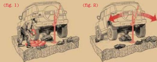
**Fig. 1:** Antes de levantarlo, asegúrate de que tienes un buen punto de enganche y una base sólida. Una vez que el vehículo ha sido elevado por encima de la obstrucción, coloca rocas o ramas caídas bajo las ruedas para obtener la tracción o la altura necesaria, luego baja el vehículo y sal de ahí. **Fig. 2:** Otra opción es poner una "pértiga" bajo el vehículo elevado y empujarlo hasta que caiga a tierra firme.
