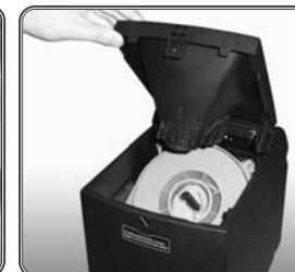
Para destrabar el equipo, desatornille la tapa superior y remueva el disco central.
