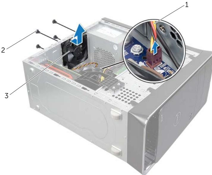
1 Cable del ventilador del chasis
