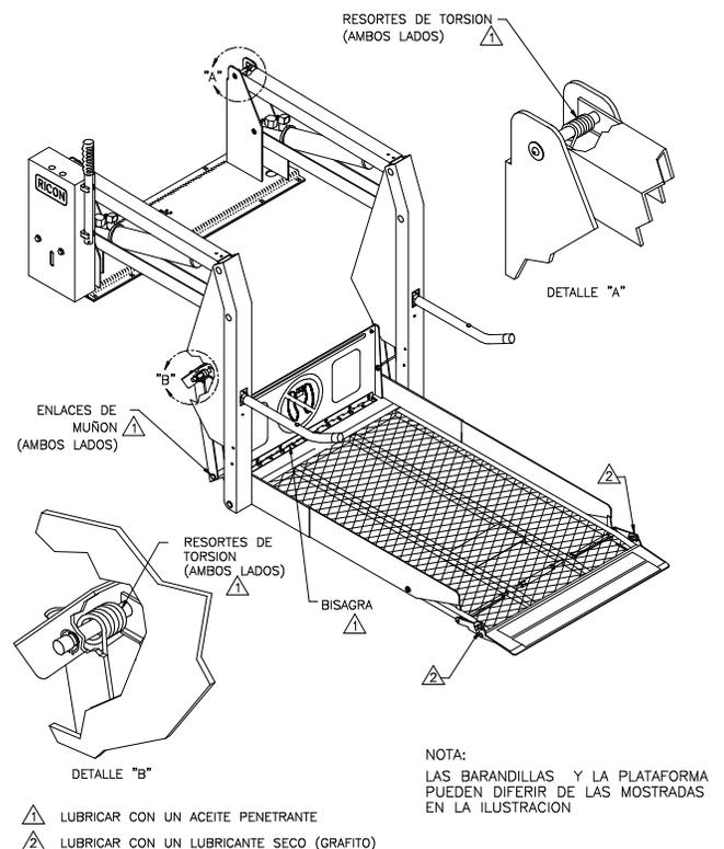
**FIGURA [14]: PUNTOS DE LUBRICACION DEL ELEVADOR**
