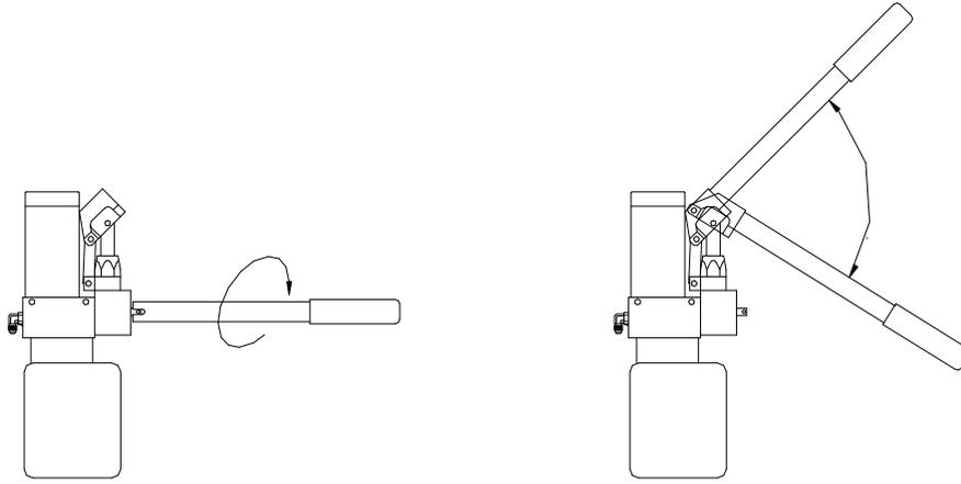
**FIGURA [10]: ELEVACION MANUAL DE LA PLATAFORMA**
