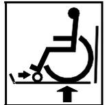
C Cerciórese de que la silla esté situada con seguridad dentro del perímetro de la plataforma y no interfiera con la operación de la aleta detenedora de la plataforma.
