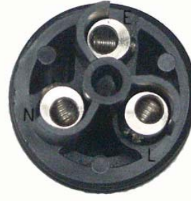
Şekil 5: Kablo Bağlantıları Kahverengi kablo terminal L'ye Mavi kablo terminal N'ye Yeşil/Sarı kablo terminal E'ye
